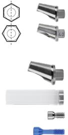
Les abutments VARIO 17° sont dotés d'une vis à 6 pans, type A (0°) ou B (30°) afin de permettre un positionnement de l'abutment exact par pas de 30°.
